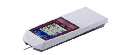
Fig. 3: Surf Test (MITUTOYO SJ-210)
